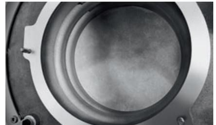
Die großzügig ausgelegte Wärmeübertragungsfläche ist die Voraussetzung für einen effizienten und modulierenden Betrieb. Dadurch wird eine brennwertoptimierte Betriebsweise ermöglicht. Dank der konstruktiven Ausführung mit glatten Oberflächen werden Verschmutzungen reduziert. Robuste Kesselglieder aus modernem Aluminiumguss sorgen für eine lange Lebensdauer. Der gut einsehbare Feuerraum gewährleistet eine leichte Zugänglichkeit.
