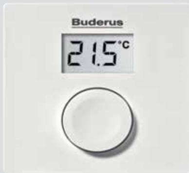
Couplé au module de commande de système RC300, le RC100 peut être utilisé comme une commande à distance très simple d'utilisation et comme une sonde de température ambiante. Le RC100 convient également parfaitement comme régulateur standard de température ambiante pour un seul circuit de chauffage. Dans ce rôle, il permet d'économiser jusqu'à 3 % d'énergie par rapport à un simple régulateur Marche/Arrêt en modulant efficacement le fonctionnement de l'installation de chauffage.
