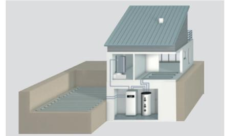
Wärmepumpen und Solar sind kein Widerspruch. Während die Solaranlage im Sommer das warme Wasser erzeugt, kann die Wärmepumpe zusammen mit der Passiven Kühlstation für angenehme Raumtemperaturen sorgen.
